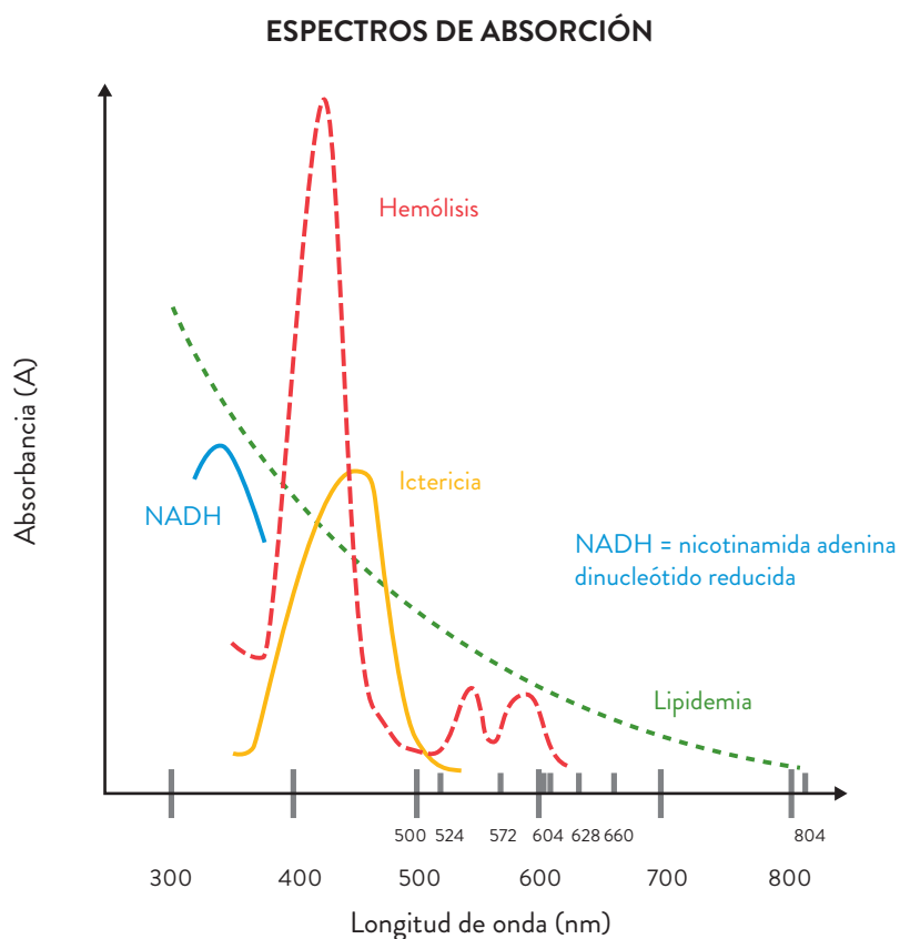
Figura 5-3: Las absorbancias debidas a la hemoglobina, ictericia (bilirrubina) y lipidemia pueden medirse en regiones utilizadas para la interpretación espectral de analitos y, por tanto, su absorbancia se puede confundir con el colorante que se está midiendo. Al realizar mediciones de absorbancia en las siete longitudes de onda designadas, pueden estimarse las concentraciones de cada una de estas sustancias de interferencia.
